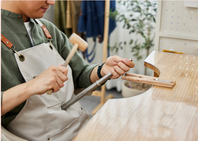
유동현 전임연구원이 은색바를 지한봉에 넣어 망치질 하는 모습
